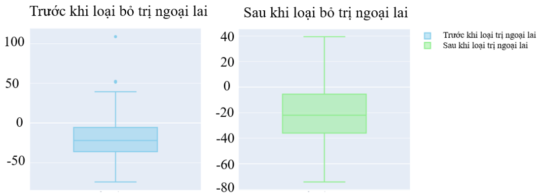
Hình 3. Biểu đồ hộp trước và sau khi loại bỏ trị ngoại lai outlier.
